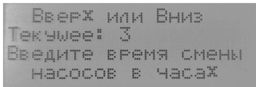
Если установить время смены насосов **больше** установленного интервала работы, смены насосов не произойдет.
