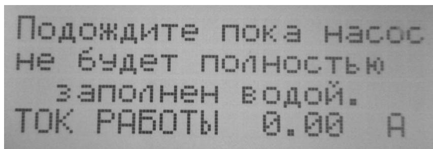
После нажатия на кнопку энкодера будет запущен процесс калибровки. На насос фильтровальной установки будет подано напряжение. В процессе работы насоса значение тока будет стабилизироваться. Для окончания калибровки необходимо нажать на энкодер.
