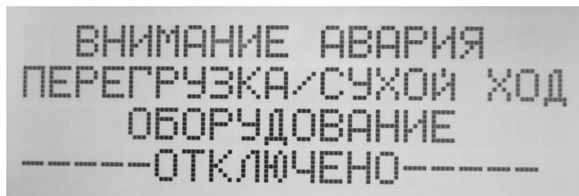
Чтобы выйти в нормальный режим работы необходимо выключить панель управления, устранить причину аварии, включить панель и выбрать пункт меню : «Работа», либо подождать 60 секунд до автоматического запуска.
