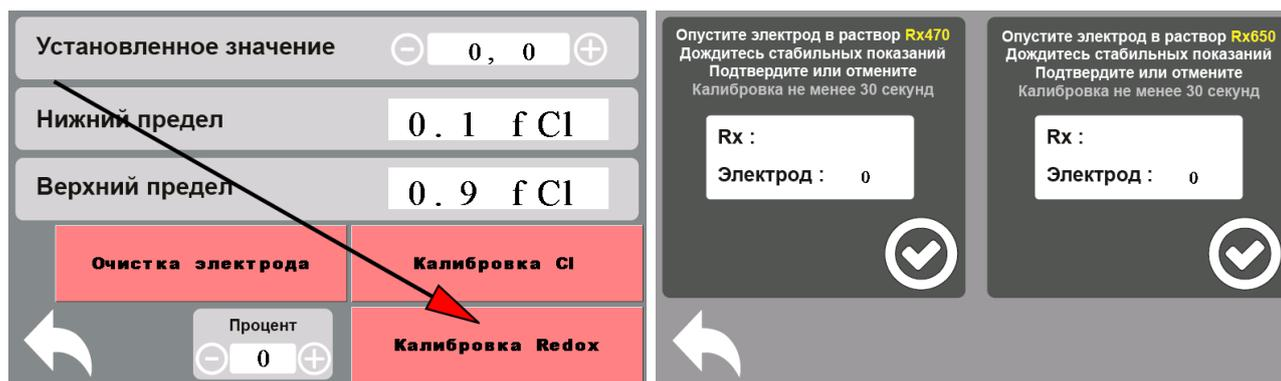
Электрод на показатель Cl калибруется по показаниям фотометра либо при помощи другого измерительного прибора
