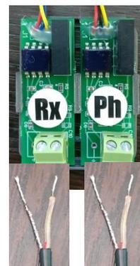
Подключение проводов электрода С1 к плате усилителя:
