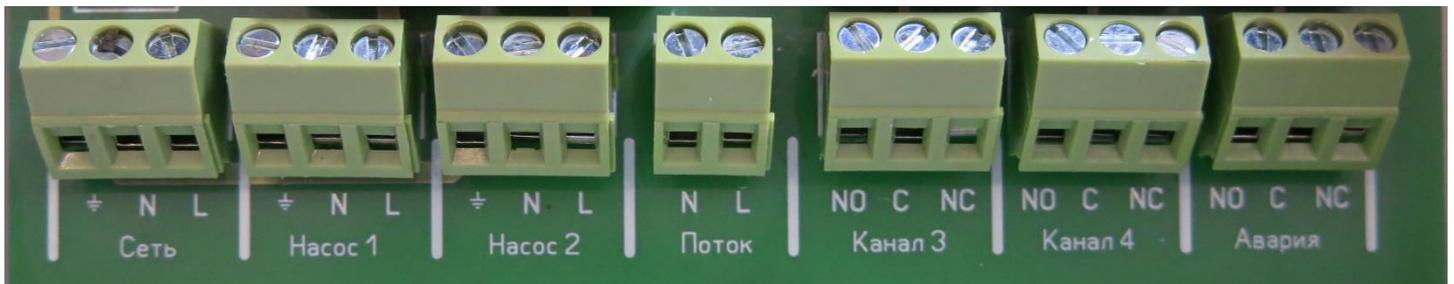
К клемме **СЕТЬ** подключается три кабеля питания. Запрещается менять местами провода «Фаза» и «Ноль». Подключать нужно в точности в соответствии с рисунком.
