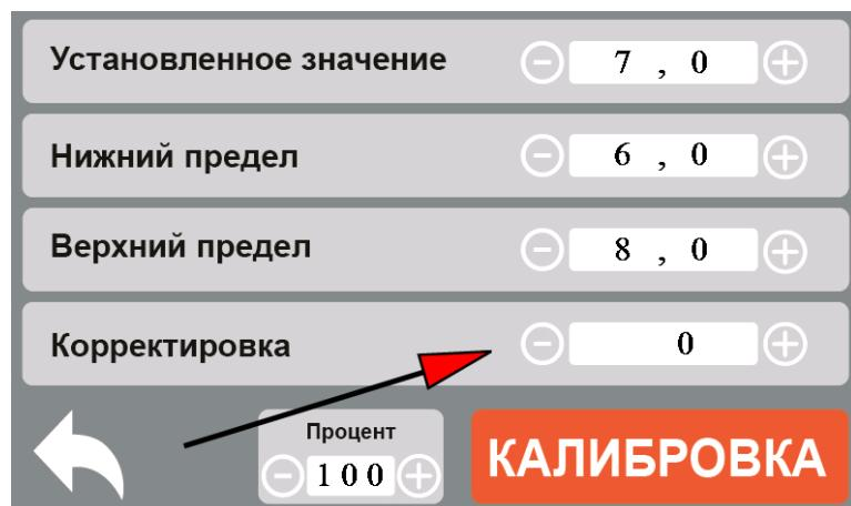
Коррекция Ph = (значение по фотометру) – (значение Ph по прибору)
