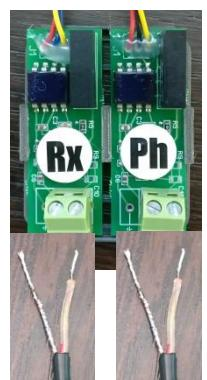
Подключение проводов электрода Cl к плате усилителя:
