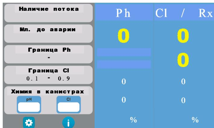
На дисплее устройства, имеется информация по показателям Ph Rx и Сд воды плавательного бассейна
