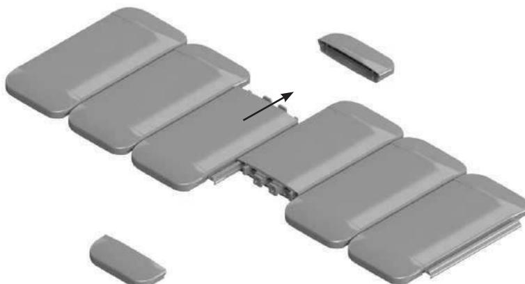
снимите защитный кожух
