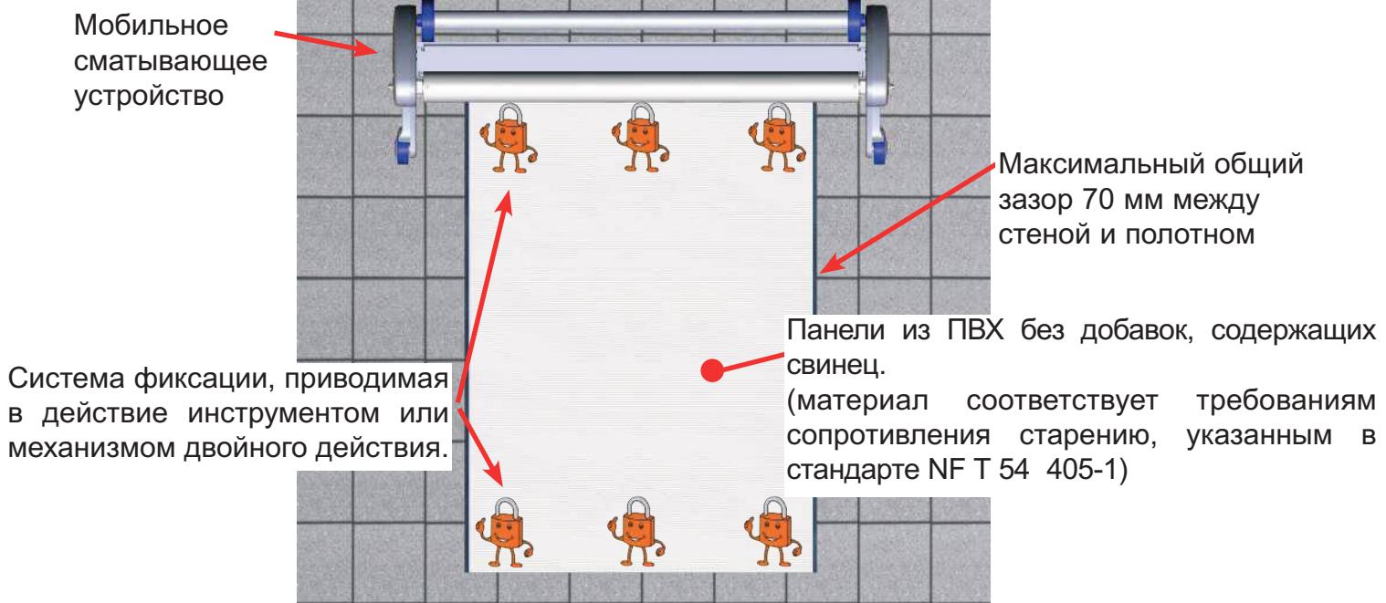
**В настоящее время жалюзи для бассейнов с переливом, а также со съемной боковой лестницей не соответствуют стандарту NF P 90-308. За исключением оговоренных производителем случаев аварийные устройства, срабатывающие от погружения, не совместимы с автоматическим сматывающим устройством компании DEL.**
